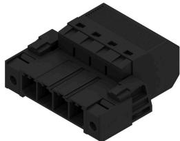
180°-invertierte Stiftleiste mit PUSH IN Anschlusstechnologie für die Feldverdrahtung in 6 mm<sup>2</sup> im Raster 7.62 als "Dreiflanschvariante" zur Gehäusedurchführung. Geeignet für Gehäuse mit einer Wandstärke von max. 2mm. Ideal auch als fingersichere Lösung bei Rückspannung. Erfüllt die Anforderungen gemäß UL1059 600 V Class C und IEC 61800-5-1
