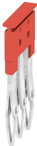
Die Verteilung oder Vervielfältigung eines Potentials auf benachbarte Reihenklemmen wird über eine Querverbindung realisiert. Zusätzlicher Verdrahtungsaufwand lässt sich so einfach vermeiden. Auch bei ausgebrochenen Polen ist weiterhin eine Kontaktsicherheit in den Reihenklemmen gewährleistet. Unser Portfolio bietet steck- und schraubbare Querverbindungssysteme für Reihenklemmen an.
