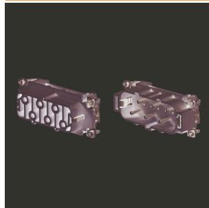
Mit der HSB Serie realisieren Anwender 35 A gleichzeitig über jeden Kontakt. Die Montage erfolgt mit Schraubanschluss, was zu einer sicheren und zuverlässigen Verbindung führt. Die Leiteranschlussebene ist als Schraubelement ausgelegt. Alle Schraubanschlusselemente sind mit einer Drahtschutzfeder ausgestattet.
