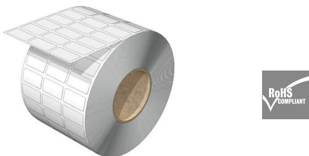
THM GEW Gewebeetiketten werden aus einem sehr flexiblen Baumwollgewebe hergestellt. Die Lieferform auf Rolle für den Einsatz mit Thermotransferdruckern erlaubt eine dickere Kleberschicht als bei A4 Bögen für den Office-Laserdrucker. Beides, die Flexibilität und die dicke Kleberschicht, ergeben höhere Klebkraftwerte und ermöglichen den Einsatz auf winkligen oder runden Objekten, wie z.B. Kabeln oder Schläuchen.
