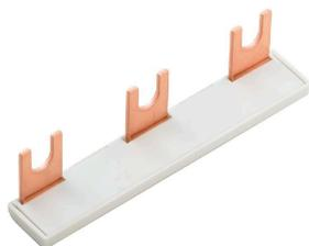
Die Verteilung oder Vervielfältigung eines Potentials auf benachbarte Reihenklennen wird über eine Querverbindung realisiert. Zusätzlicher Verdrahtungsaufwand lässt sich so einfach vermeiden. Auch bei ausgebrochenen Polen ist weiterhin eine Kontaktsicherheit in den Reihenklennen gewährleistet. Unser Portfolio bietet steck- und schraubbare Querverbindungssysteme für Reihenklennen an.
