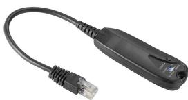
Modul zum Speichern und Laden einer Gerät konfiguration
