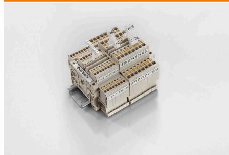
SnapMark - Dieser Schildträger ist speziell für die Doppelstockklemme IDK 1.5N der I-Reihe entwickelt worden. Durch den flexiblen Schwenkmechanismus lassen sich Querverbindungen ohne Aufwand montieren oder entnehmen. Er kann mit vier DEK 5 Bezeichnungsschildern oder zwei WS 10/5 Middle Verbindermarkieren bestückt werden.
