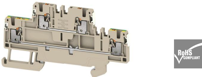
Das Durchführen von Energie, Signalen und Daten ist die klassische Anforderung in der Elektrotechnik und im Schaltschrankbau. Die maßgeblichen Merkmale sind dabei der Isolierstoff, die Anschlusstechnik und der Aufbau der Reihenklemmen. Mithilfe von Durchgangsreihenklemmen können ein oder mehrere Leiter zusammengeführt und/oder angeschlossen werden. Sie können eine oder mehrere Anschlussebenen haben, die auf dem gleichen Potenzial liegen oder voneinander getrennt sind.
