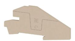
Abschlussplatten werden an der offenen Seite der letzten Reihenklemme vor dem Endwinkel befestigt. Mit dem Einsatz der Abschlussplatte wird die Funktion der Reihenklemme sowie die angegebenen Bemessungsspannung aufrechterhalten. Ein Berührungsschutz von Spannungsführenden Teilen wird gewährleistet, und die Abschlussklemme ist fingersicher.
