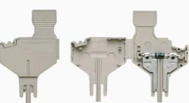
Der Bauelementstecker dient dem integrieren einer elektrischen Komponente in einer Trennreihenklemme. Nach dem Einlöten der jeweiligen Komponente lässt sich der Stecker in den Trennbereich unserer Reihenklemmen integrieren und ändert dadurch die Trennklemme zu einer Reihenklemme mit integrierter elektronischen Komponente.
