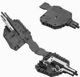
Der Sicherungshalter SIHA macht im Handumdrehen aus einer Trennklemme eine Sicherungsklemme: Einfach den Trennhebel entfernen und den Sicherungsstecker aufstecken.
