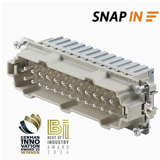
Bei dem SNAP IN-Anschluss ist die Leiteranschlussebene bereits geöffnet und der abgesetzte Leiter kann einfach eingesteckt werden. In der Endposition schliesst der patentierte Klemmmechanismus automatisch. Dadurch ist sie praktisch wartungsfrei und es besteht eine sichere und dauerhafte Verbindung, welche rüttelfest ausgelegt ist. Weidmüller bietet somit als erster und einziger Hersteller diese neuartige Anschlusstechnik.
