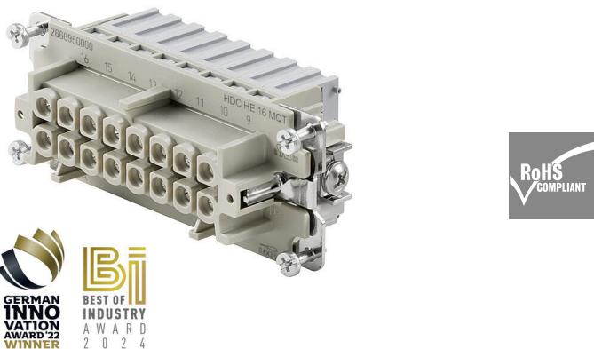
Bei dem SNAP IN-Anschluss ist die Leiteranschlussebene bereits geöffnet und der abgesetzte Leiter kann einfach eingesteckt werden. In der Endposition schliesst der patentierte Klemmmechanismus automatisch. Dadurch ist sie praktisch wartungsfrei und es besteht eine sichere und dauerhafte Verbindung, welche rüttelfest ausgelegt ist. Weidmüller bietet somit als erster und einziger Hersteller diese neuartige Anschlusstechnik.
