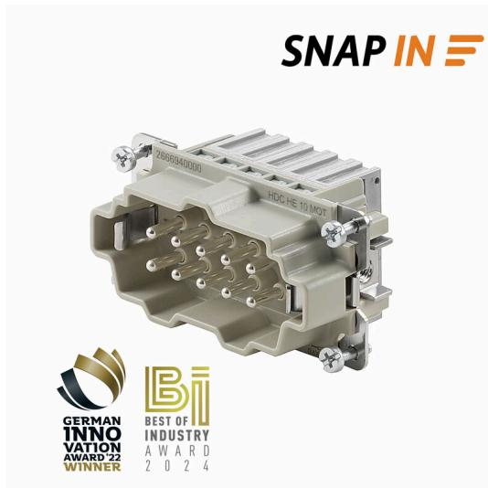
Bei dem SNAP IN-Anschluss ist die Leiteranschlussebene bereits geöffnet und der abgesolerte Leiter kann einfach eingesteckt werden. In der Endposition schliesst der patentierte Klemmmechanismus automatisch. Dadurch ist sie praktisch wartungsfrei und es besteht eine sichere und dauerhafte Verbindung, welche rüttelfest ausgelegt ist. Weidmüller bietet somit als erster und einziger Hersteller diese neuartige Anschlusstechnik.
