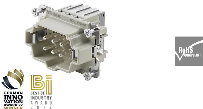
Bei dem SNAP IN-Anschluss ist die Leiteranschlussebene bereits geöffnet und der abgesetzte Leiter kann einfach eingesteckt werden. In der Endposition schließt der patentierte Klemmmechanismus automatisch. Dadurch ist sie praktisch wartungsfrei und es besteht eine sichere und dauerhafte Verbindung, welche rüttelfest ausgelegt ist. Weidmüller bietet somit als erster und einziger Hersteller diese neuartige Anschlusstechnik.
