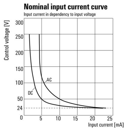
Eingangsstrom ist abhängig von der Eingangsspannung
