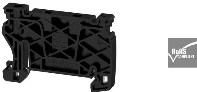
Um einen dauerhaft sicheren Sitz auf der Tragschiene zu gewährleisten und ein verrutschen zu verhindern hat Weidmüller Endwinkel im Programm. Es sind Ausführungen mit Schraube und schraubenlose Ausführungen erhältlich. Auf den Endwinkeln bestehen Markierungsmöglichkeiten, ebenfalls für Gruppenmarkierer und die Möglichkeit der Aufnahme für Prüfstecker.
