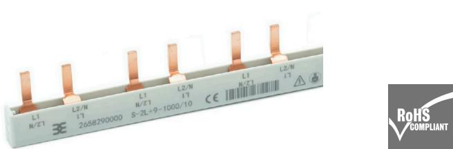
2-polige Phasenschienen mit Stiftkontakt dienen der Potentialverteilung auf weiteren Komponenten im Schaltschrank wie den Leistungsschutzschaltern, Fehlerstromschutzschaltern und anderen Installationsgeräten.
