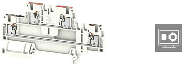
Klippon® Connect-KNX-Reihenklemmen ermöglichen die Verdrahtung der Haupt- und Reserveadern eines KNX-Bussystems auf nur 7 mm Baubreite. Ein doppelter Quer-verbindungsschacht pro Ebene sorgt für die unkomplizierte Potenzialverteilung innerhalb des Klemmblocks.
