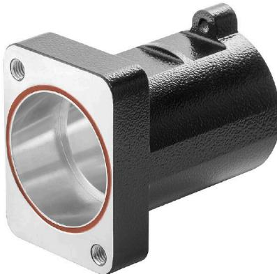
Das schützende Gehäuse ist aus einem seewasserbeständigen Aluminium im Druckgussverfahren hergestellt. Hohe Anforderungen an Wasser – und Staubschutz, so wie eine besonders hohe Schlagfestigkeit zeichnet diese Gehäusereihe aus. Eine aufwendige, zweistufige Oberflächenbeschichtung schafft Sicherheit für Jahre. Alle im Aussenbereich verwendeten Schrauben, Verriegelungsbügel und sonstigen Zubehörteile sind aus korrosionsresistentem Edelstahl gefertigt.
