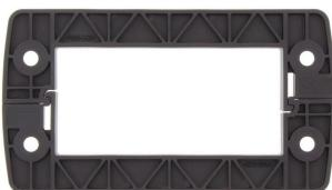
Der aus einem Stück gefertigte, einteilige Rahmen ist schnell und einfach zu montieren und besteht aus formstabilem, glasfaserverstärktem Kunststoff. Die unverlierbare eingeschäumte Dichtung garantiert eine hohe Dichtigkeit von IP66 nach DIN EN 60529, auch an lackierten und rauen Oberflächen.
