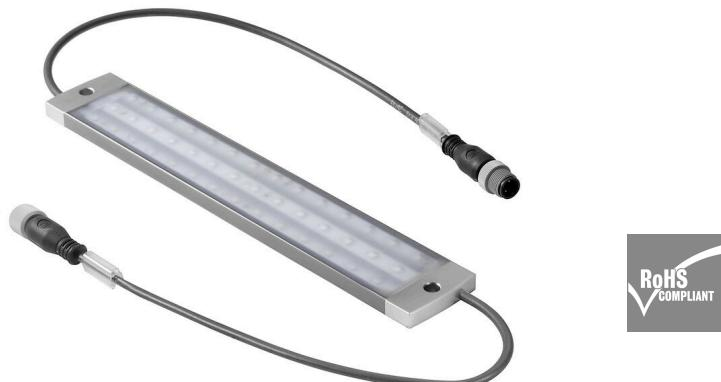
Die WIL-LED Leuchten Familie: Nur 8mm (9,4mm mit Magnet) hohe LED Lampe für 24V DC mit sehr hoher Lichtausbeute und hoher Lebensdauer (Größer 60 000h). Sehr robuste Bauweise, durch Vollverguss und Metallgehäuse - wasserdicht (IP67). Durch seine blaue Lichtfarbe geeignet für spezielle Farbeffekte. Optional mit M12 Anschluss sehr leicht anschließbar. Durch die geringe Stromaufnahme reicht ein kleines Netzteil mit 24V zum Betrieb.
