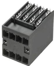
Zweireihige Hochstrom High Performance Stifteleisten, mit oder ohne Flansch zur schnellen, werkzeuglosen Verriegelung. Optimiert für „Book- Size Module“ ab einer Baubreite von 50mm. Mit integrierte Befestigungsmöglichkeit an der Gehäusewand. Höchste Bedienungs- und Betriebssicherheit durch 100% fehlstecksicheres Steckgesicht, einzigartige Kodiervielfalt und optional zusätzlicher Schraubbefestigung im Flansch.
