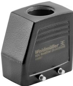
Die neuen Weidmüller RockStar® IP65 EMV Gehäuse sind für den Einsatz unter härtesten Umweltbedingungen und bei gleichzeitigem Schutz vor Störeinstrahlung bestens geeignet. Ein schwerer Steckverbinder besteht aus einem Steckverbindereinsatz und dem Gehäuse. Die neuen Kunststoffbügel sind leicht zu verriegeln und jederzeit austauschbar. Alle Weidmüller RockStar® Gehäuse bestehen aus hochwertigem Aluminiumdruckguss. Sie sind somit schlagfest, korrosionsfest und trotzdem kompakt und leicht.
