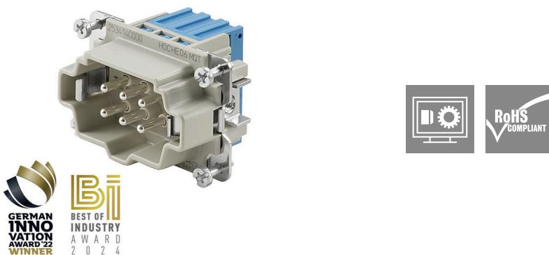
Bei dem SNAP IN-Anschluss ist die Leiteranschlussebene bereits geöffnet und der abgesetzte Leiter kann einfach eingesteckt werden. In der Endposition schliesst der patentierte Klemmmechanismus automatisch. Dadurch ist sie praktisch wartungsfrei und es besteht eine sichere und dauerhafte Verbindung, welche rüttelfest ausgelegt ist. Weidmüller bietet somit als erster und einziger Hersteller diese neuartige Anschlusstechnik.
