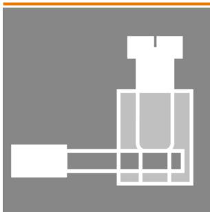
M12-Steckverbinder in IP 67 mit Schraub- oder Zugfederanschluss verfügbar
