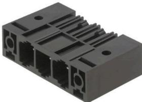
Einreihige High Performance Stiftleiste, polverlustfrei anreihbar oder mit patentiertem Flansch zur schnellen, werkzeuglosen Verriegelung. Höchste Bedienungs- und Betriebssicherheit durch 100% fehlstecksicheres Steckgesicht, einzigartige Kodiervielfalt und Zusatzbefestigung im Flansch. Stiftlänge mit 3,5 mm optimiert für den Wellenlötprozess, Steckrichtung 270° zu den Lötstiften.
