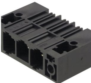
Einreihige Hochstrom-Stiftleiste, polverlustfrei anreihbar oder mit patentiertem Flansch zur schnellen, werkzeuglosen Verriegelung. Höchste Bedienungs- und Betriebssicherheit durch 100% fehlstecksicheres Steckgesicht, einzigartige Kodiervielfalt und Zusatzbefestigung im Flansch. Stiftlänge mit 3,5 mm optimiert für den Wellenlötprozess Steckrichtung 90° zu den Lötstiften.
