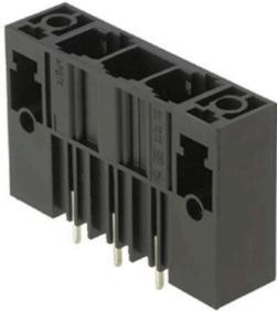
Einreihige Hochstrom-Stiftleiste, polverlustfrei anreihbar oder mit patentiertem Flansch zur schnellen, werkzeuglosen Verriegelung. Höchste Bedienungs- und Betriebssicherheit durch 100% fehlstecksicheres Steckgesicht, einzigartige Kodiervielfalt, Zusatzbefestigung und integrierbare Positionierhilfe. Stiftlänge mit 3,5 mm optimiert für den Wellenlötprozess, Steckrichtung 180° zu den Lötstiften.
