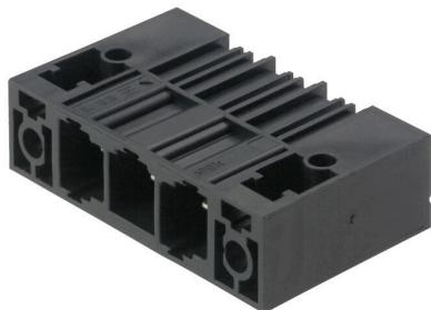
Einreihige Hochstrom-Stifteleiste, polverlustfrei anreihbar oder mit patentiertem Flansch zur schnellen, werkzeuglosen Verriegelung. Höchste Bedienungs- und Betriebssicherheit durch 100% fehlstecksicheres Steckgesicht, einzigartige Kodicrielfalt und Zusatzbefestigung im Flansch. Stiftlänge mit 3,5 mm optimiert für den Wellenlötprozess Steckrichtung 90° zu den Lötstiften.
