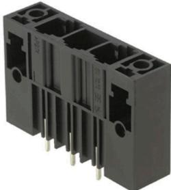
Einreihige Hochstrom-Stiftleiste, polverlustfrei anreichbar oder mit patentiertem Flansch zur schnellen, werkzeuglosen Verriegelung. Höchste Bedienungs- und Betriebssicherheit durch 100% fehlstecksicheres Steckgesicht, einzigartige Kodiervielfalt, Zusatzbefestigung und integrierbare Positionierhilfe. Stiftlänge mit 3,5 mm optimiert für den Wellenlötprozess, Steckrichtung 180° zu den Lötstiften.
