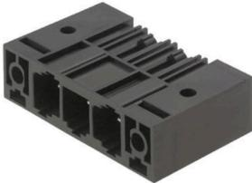
Einreihige High Performance Stiftleiste, polverlustfrei anreichbar oder mit patentiertem Flansch zur schnellen, werkzeuglosen Verriegelung. Höchste Bedienungs- und Betriebssicherheit durch 100% fehlstecksicheres Steckgesicht, einzigartige Kodiervielfalt und Zusatzbefestigung im Flansch. Stiftlänge mit 3,5 mm optimiert für den Wellenlötprozess, Steckrichtung 270° zu den Lötstiften.
