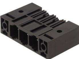
Einreihige High Performance Stiftleiste, polverlustfrei anreihbar oder mit patentiertem Flansch zur schnellen, werkzeuglosen Verriegelung. Höchste Bedienungs- und Betriebssicherheit durch 100% fehlstecksicheres Steckgesicht, einzigartige Kodiervielfalt und Zusatzbefestigung im Flansch. Stiftlänge mit 3,5 mm optimiert für den Wellenlötprozess, Steckrichtung 270° zu den Lötstiften.
