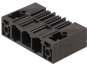
Einreihige Hochstrom-Stiftleiste, pulverlustfrei anreihbar oder mit patentiertem Flansch zur schnellen, werkzeuglosen Verriegelung. Höchste Bedienungs- und Betriebssicherheit durch 100% fehlstecksicheres Steckgesicht, einzigartige Kodiervielfalt und Zusatzbefestigung im Flansch. Stiftlänge mit 3,5 mm optimiert für den Wellenlötprozess Steckrichtung 90° zu den Lötstiften.
