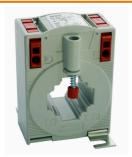
Aufsteck-Stromwandler Aufsteckstromwandler kommen überall dort zum Einsatz, wo hohe Ströme von bis zu 5000A erfasst und weiterverarbeitet werden sollen. Unsere Aufsteckstromwandler liefern dabei Sekundärströme von 1A oder 5A. Zusätzlich bietet Weidmüller kompakte Low-Power Stromwandler an, um Ströme bis zu 600 A zu Spannungen bis 333 mV zu wandeln.
