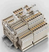
**SnapMark** - Dieser Schildträger ist speziell für die Doppelstockklemme IDK 1.5N der I-Reihe entwickelt worden. Durch den flexiblen Schwenkmechanismus lassen sich Querverbindungen ohne Aufwand montieren oder entnehmen. Er kann mit vier DEK 5 Bezeichnungsschildern oder zwei WS 10/5 Middle Verbindermarkieren bestückt werden.
