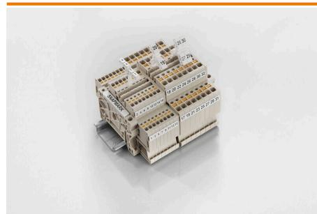
SnapMark - Dieser Schildträger ist speziell für die Doppelstockklemme IDK 1.5N der I-Reihe entwickelt worden. Durch den flexiblen Schwenkmechanismus lassen sich Querverbindungen ohne Aufwand montieren oder entnehmen. Er kann mit vier DEK 5 Bezeichnungsschildern oder zwei WS 10/5 Middle Verbindelementen bestückt werden.
