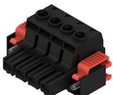
High Performance Buchsenleiste mit dem bewährten, 100% wartungsfreien Weidmüller-Stahlzugbügel. Polverlustfrei anreichbar oder mit patentiertem Multifunktionsflansch zur sicheren, schnellen und werkzeuglosen Verriegelung. Höchste Bedienungs- und Betriebssicherheit durch 100% fehlstecksicheres Steckgesicht, einzigartige Kodiervielfalt, Fehlverdrahtungsschutz und 4-Punkt-Silber-Kontakt.
