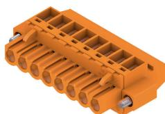
Buchsenstecker mit Schraubanschluss in Zugbügeltechnik für Leiteranschluss mit rechtwinkliger (90° bzw. 270°) Abgangsrichtung. Die Buchsenstecker bieten Platz für Beschriftungen und können kodiert werden. Befestigung mittels Flansch oder Löseriegel möglich. Sie bieten zusätzlich integrierte Plus/Minus-Schraube, Leiteruntersteckschutz und werden mit geöffnetem Zugbügel geliefert. HC = High Current.
