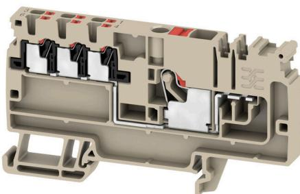
Das einzigartig modulare Konzept lässt sich auf jeden Maschinentyp anpassen. Die Potenzialverteilerreihenklemmen AAP überzeugen durch einheitliches Design mit zwei möglichen Aufbauten – alternierend oder gruppiert. Bei dem gruppierten Aufbau der Steuerstromverteilung befinden sich die Potentiale auf unterschiedlichen Reihenklemmen und Bilden darum ganze Potentialblöcke.
