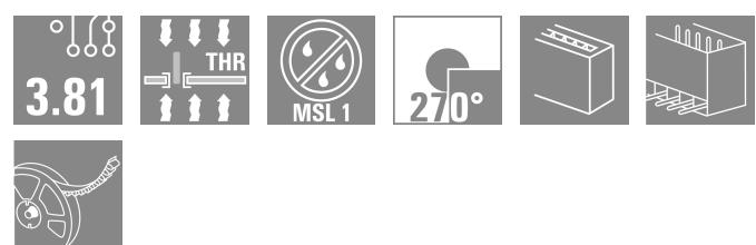
Die hochtemperaturfeste Stiftleiste SC-SMT in 270°-Abgangsrichtung - der Winkel von 270° wird definiert zwischen Steckrichtung und Lötpin und kennzeichnet die Steckrichtung parallel zur Leiterplatte, jedoch für das Stecken von Buchsenleisten über Kopf.
