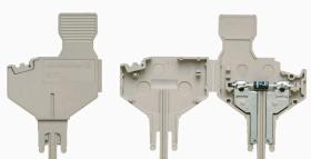
Der Bauelementestecker dient dem integrieren einer elektrischen Komponente in einer Trennreihenklemme. Nach dem Einlöten der jeweiligen Komponente lässt sich der Stecker in den Trennbereich unserer Reihenklemmen integrieren und ändert dadurch die Trennklemme zu einer Reihenklemme mit integrierter elektronischen Komponente.
