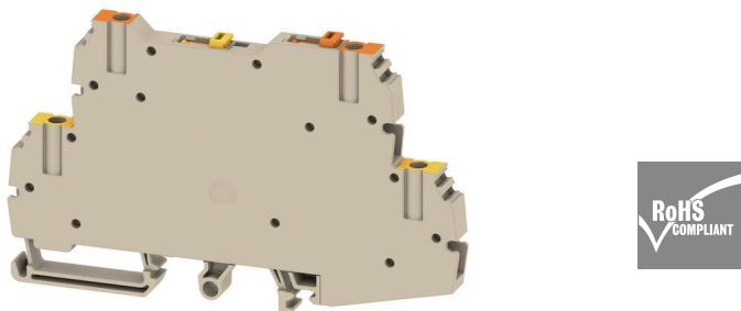
Bei einigen Anwendungen ist ein Prüfabgriff oder ein Trennelement an der Durchgangsklemme für Test- und Sicherheitszwecke sinnvoll. Mit Prüftrennreihenklemmen messen Sie Stromkreise im spannungsfreien Zustand. Während Luft- und Kriechstrecken der Trennstellen nicht maßlich beurteilt werden, muss die angegebene Bemessungsstoßspannungsfestigkeit nachgewiesen werden.
