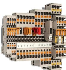
Bei einigen Anwendungen ist ein Prüfabgriff oder ein Trennelement an der Durchgangsklemme für Test- und Sicherheitszwecke sinnvoll. Mit Prüftrennreihenklemmen messen Sie Stromkreise im spannungsfreien Zustand. Während Luft- und Kriechstrecken der Trennstellen nicht maßlich beurteilt werden, muss die angegebene Bemessungsstoßspannungsfestigkeit nachgewiesen werden.
