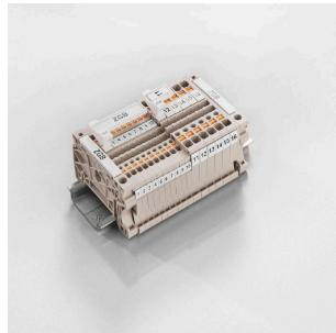
Der ZGB 15 ist ein schwenkbarer Gruppenschildträger. Der Schildträger kann mit den Klemmenmarkierern dekafix 5, WS 12/5 oder dem Einstekschild ESO 15 bestückt werden. Der ZGB 30 ist ein schwenkbarer Gruppenschildträger. Der Schildträger kann mit den Klemmenmarkierern dekafix 5, WS 12/5 oder dem Einstekschild ESO 7 bestückt werden. Einstekschilder und Schutzstreifen befinden sich unter Zubehör.
