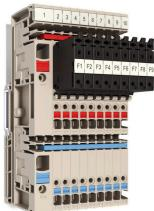
Das einzigartig modulare Konzept lässt sich auf jeden Maschinentyp anpassen. Die Potenzialverteilerreihenklemmen AAP überzeugen durch einheitliches Design mit zwei möglichen Aufbauten – alternierend oder gruppiert. Bei dem alternierenden Aufbau der Steuerstromverteilung befinden sich beide Potentiale auf nur einer Reihenklemme.
