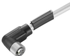
Ihre Geräte in der Peripherie sollen mit großer Leistung versorgt werden. Mit unseren neuen M12-Steckverbinder sind mehr als 250 V und 2 A problemlos möglich. Die kompakten A-, K-, L-, S- und T-codierten M12-Steckverbinder sind auf die Übertragung von bis zu 630 V AC bzw. 60 V DC und 12 A ausgelegt.
