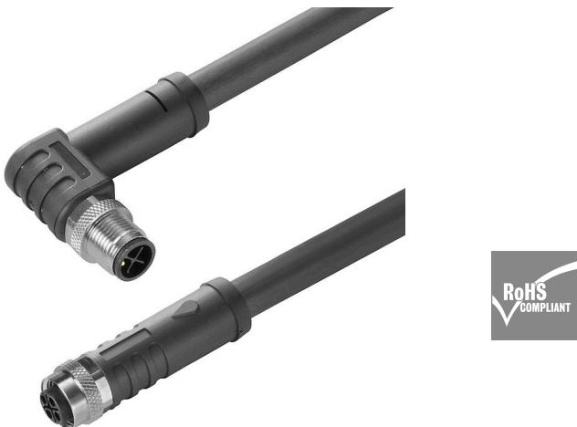
Ihre Geräte in der Peripherie sollen mit großer Leistung versorgt werden. Mit unseren neuen M12-Steckverbindern sind mehr als 250 V und 2 A problemlos möglich. Die kompakten A-, K-, L-, S- und T-codierten M12-Steckverbindern sind auf die Übertragung von bis zu 630 V AC bzw. 60 V DC und 12 A ausgelegt.
