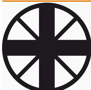
Kreuzschlitz-Schraubendreher, Typ Pozidriv, SDK PZ DIN
