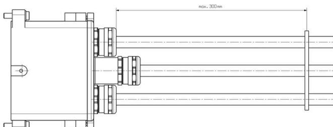
Um Beschädigungen an den Kontakten und Isolierhülsen zu vermeiden empfehlen wir eine Kabelfixierung. Die entsprechenden Abstände sind der nachfolgenden Zeichnung zu entnehmen. Die Kabelfixierung gehört nicht zum Lieferumfang.
