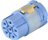
Die M23 Rundsteckverbinder bieten: Hohe Steckhäufigkeit, hohe Stromübertragbarkeit und eine hohe Kontaktdichte bei gleichzeitig geringen Abmaßen. Gehäuse, Einsätze und Crimpkontakte sind separat zu bestellen.
