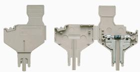
Der Bauelementstecker dient dem integrieren einer elektrischen Komponente in einer Trennreihenklemme. Nach dem Einlöten der jeweiligen Komponente lässt sich der Stecker in den Trennbereich unserer Reihenklemmen integrieren und ändert dadurch die Trennklemme zu einer Reihenklemme mit integrierter elektronischen Komponente.
