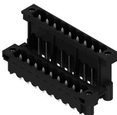
Hochtemperaturfeste, doppelstöckige, seitlich versetzte, Stifteleiste mit Flansch bzw. Lötflansch. Lötstift 1,5 mm für Reflowlötanwendungen geeignet. Lötstift 3,2 mm für Reflow- und Wellenlötanwendungen geeignet. Die Stifteleisten bieten Platz für Beschriftungen und können kodiert werden.
