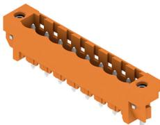
Stiftleisten aus glasfaserverstärktem Kunststoff mit gerader Abgangsrichtung optimiert für den Wellenlötprozess. Die Variante mit Flansch (F) lässt sich zur Verschraubung mit dem jeweiligen Gegenstück oder der Leiterplatte nutzen. Beim Einsatz der Lötflansch-Variante entfällt eine zusätzliche Verschraubung mit der Leiterplatte. Gleichzeitig werden die Lötstellen vor mechanischem Stress geschützt. Die Stiftleisten können manuell kodiert oder bereits vorkodiert bestellt werden. HC = High Current.
