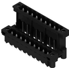
Hochtemperaturfeste, doppelstöckige, seitlich versetzte, Stiftleiste mit Flansch bzw. Lötflansch. Lötstift 1,5 mm für Reflowlötanwendungen geeignet. Lötstift 3,2 mm für Reflow- und Wellenlötanwendungen geeignet. Die Stiftleisten bieten Platz für Beschriftungen und können kodiert werden.
